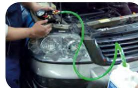
Permet un changement rapide du liquide de refroidissement sous vide.
