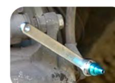
Clé et douille combinées pour faciliter le desserrage et le serrage.
