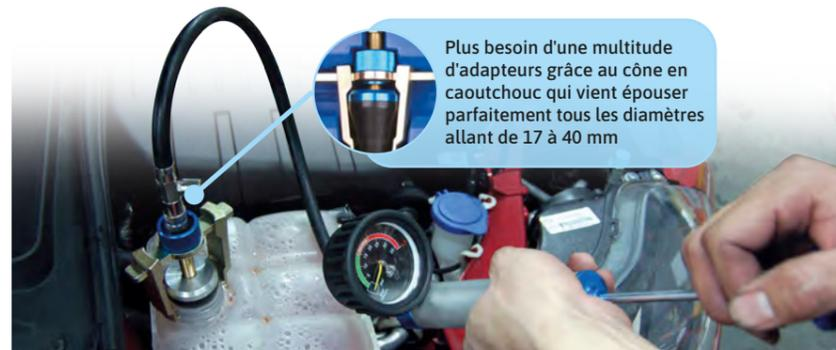
Plus besoin d'une multitude d'adaptateurs grâce au cône en caoutchouc qui vient épouser parfaitement tous les diamètres allant de 17 à 40 mm
