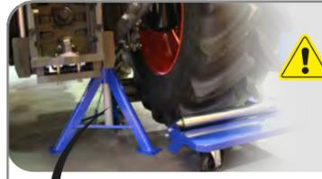
**⚠** Soutenez toujours le véhicule à l'aide de chandelles avant toute opération sous celui-ci. Il est interdit de séjourner dans, sur et sous le véhicule lorsqu'il est soulevé ou soutenu uniquement par un cric.
