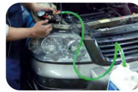
Permet un changement rapide du liquide de refroidissement sous vide.
