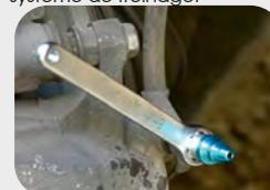
Clé et douille combinées pour faciliter le desserrage et le serrage.
