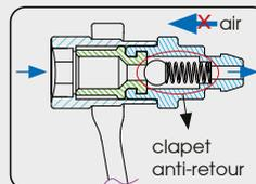
Clapet anti-retour intégré dans la clé empêchant le reflux de l'air dans le système de freinage.
