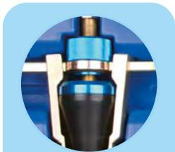
Plus besoin d'une multitude d'adaptateurs grâce au cône en caoutchouc qui vient épouser parfaitement tous les diamètres allant de 17 à 40 mm
