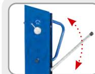
Levier avec système hydraulique pour contrôler l'écartement des rouleaux entraînant la levée et l'abaissement de la roue.
