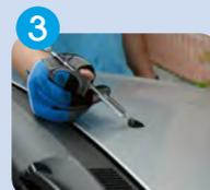
3 Aiguille pour nettoyer l'orifice d'écoulement des gicleurs d'essuie-glace.
