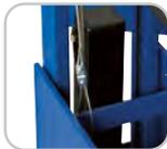
Table de presse réglée par un treuil. Traction par chaîne en option pour le levage et l'abaissement du plateau à l'aide du vérin (9HYP1400).
