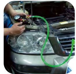
Permet un changement rapide du liquide de refroidissement sous vide.
